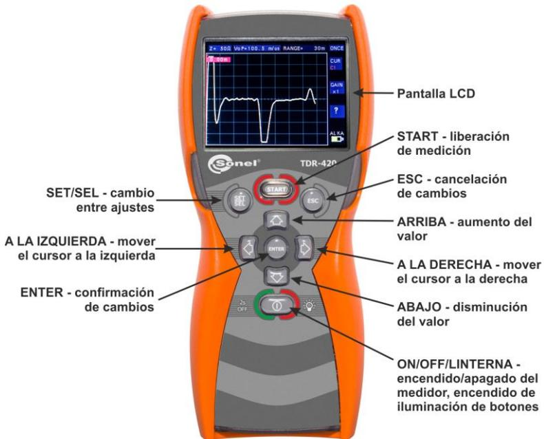
Para **encender** el reflectómetro, presionar brevemente el botón . Para **apagar** el reflectómetro, mantener presionado el botón durante unos 4 s.
